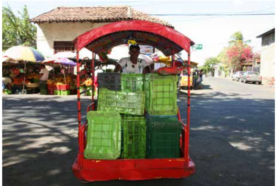
Nicaraguanisches Lastenrad – höchstes zulässiges Gesamtgewicht 400kg.
